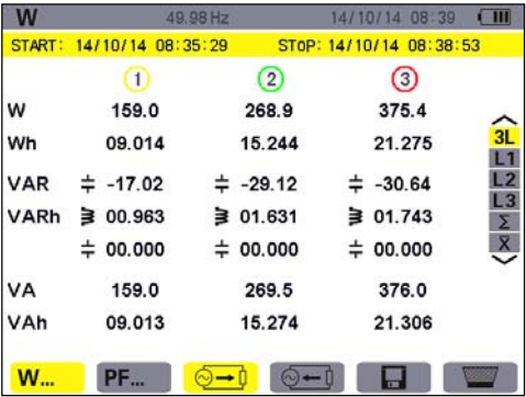
图 11-2 三相(3L)消耗电能的屏幕显示
